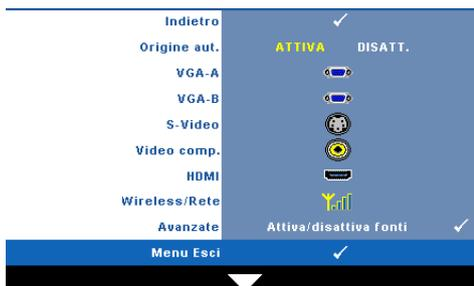
**ORIGINE AUT.**—Selezionare Disatt. (opzione predefinita) per bloccare il segnale di ingresso corrente. Se si preme il tasto **Origine** quando si imposta la modalità **Origine aut.** su **Disatt.**, è possibile selezionare manualmente il segnale di ingresso. Selezionare **Attiva** per rilevare automaticamente i segnali d'ingresso disponibili. Se
